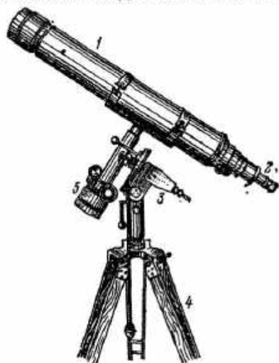
Рис. 18. Большой школьный рефрактор. 1 — тубус, 2 — окулярная часть, 3 — головка штатива, 4 — штатив, 5 — противовес.
