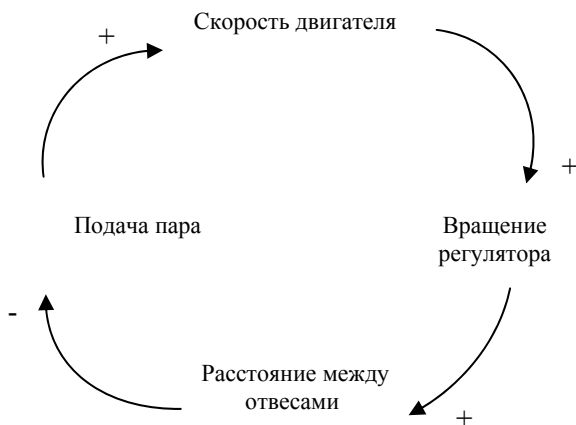
Рис. 4-5. Петля обратной связи для центробежного регулятора
